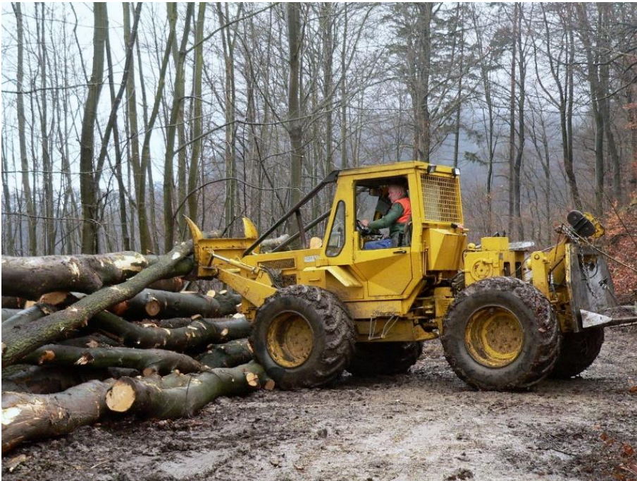
Abb. 8.3: Seilschlepper bei Polterarbeiten [Hessen Forst, K. Eidam]
