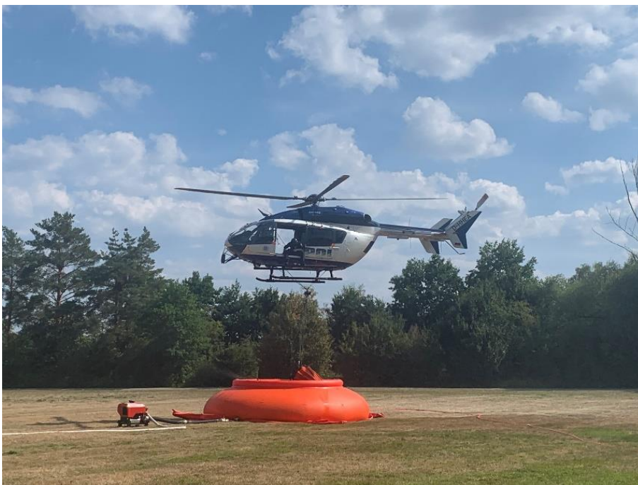
Abb. 6.10: Wasserübergabe aus der Luft [2]
