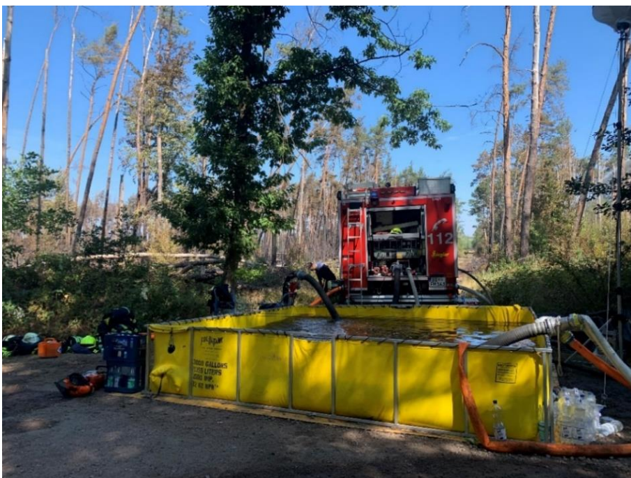
Abb. 6.8: Wasserübergabepunkt mit mobilem Wasserbehälter [HmdIS]
