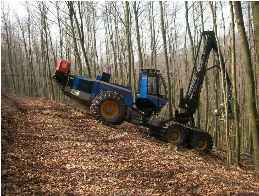
Abb. 8.1: Harvester mit Bändern bei der Laubholzernte [Hessen Forst, K. Kahle]
