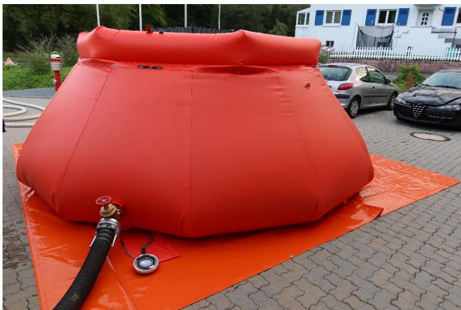
Abb. 7.2: Faltbehälter zur Löschwasserspeicherung, 15 000 Liter [FF Eppstein-Vockenhäusen]
