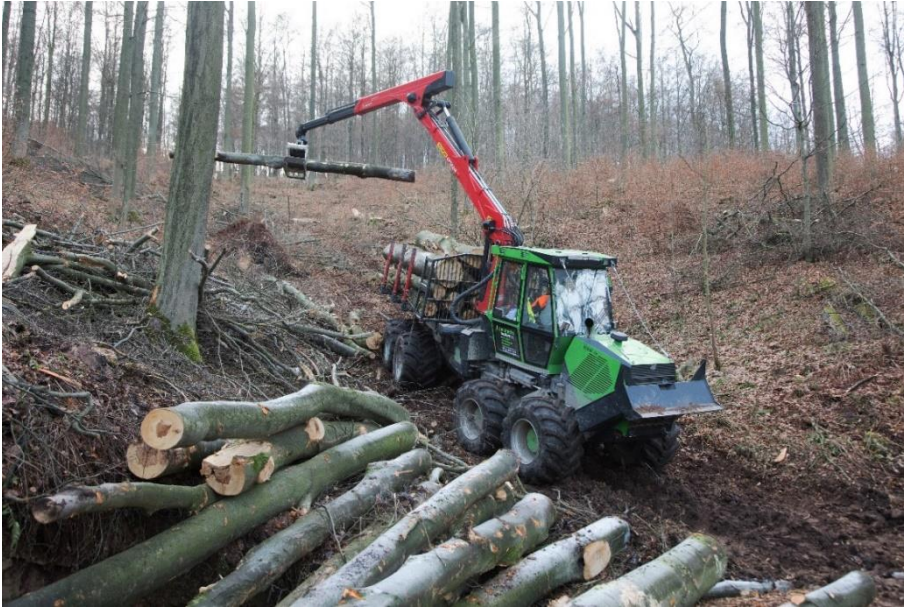
Abb. 8.2: Forwarder beim Rücken von Laubholz [Hessen Forst, L. Koch]
