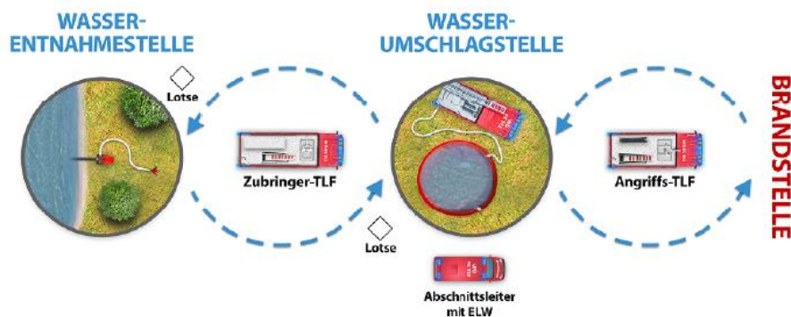
Abb. 6.7: Doppelter Pendelverkehr mit Tanklöschfahrzeugen [2]
