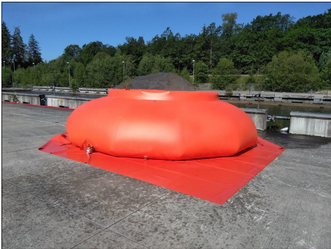
Foto: Löschwasserbehälter, Typ Faltsilo OFFB PVC 35.000 I, Quelle: HMdIS V41
